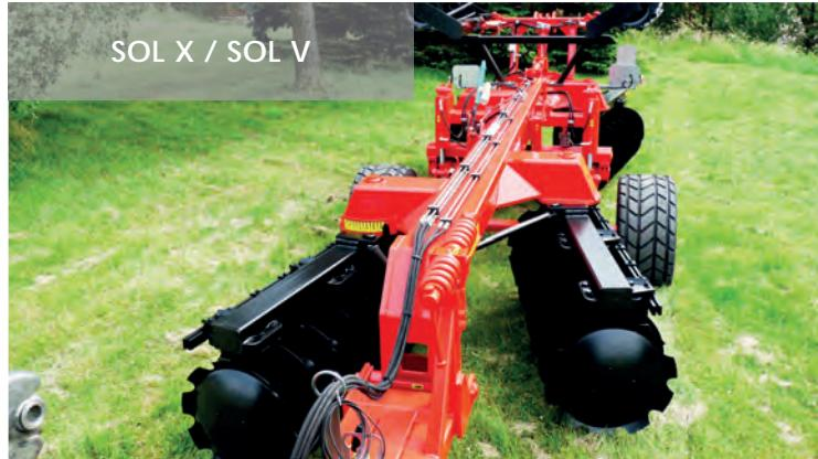
**Châssis monopoutre ■ 300 x 300 mm**
