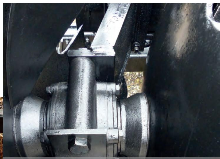
Piliers acier, roulements coniques triple étanchéité (poids 21 kg)
