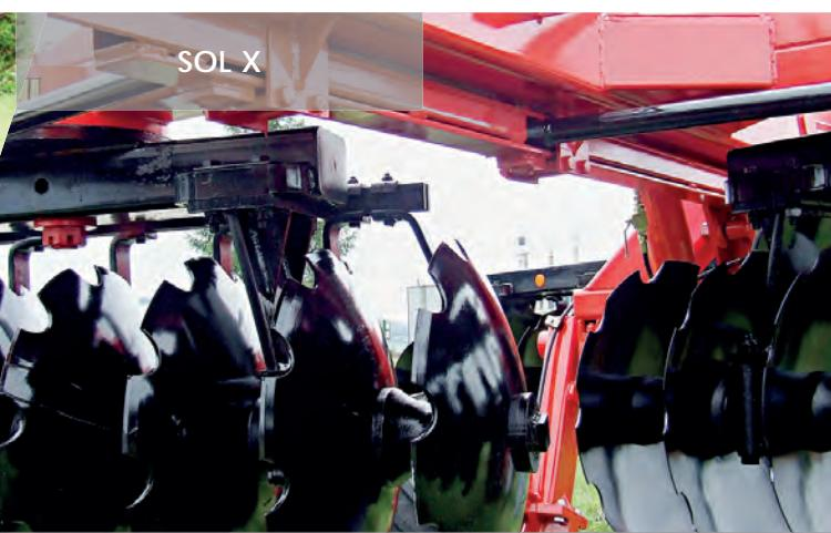
Disques crantés avant et lisses arrière (ou alternés)
